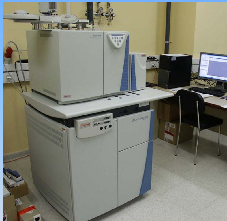
Espectómetro de masas de relacións isotópicas Deltav Advantage con analizador elemental ThermoFisher Scientific FlashEA2000 HT CHNS-O
